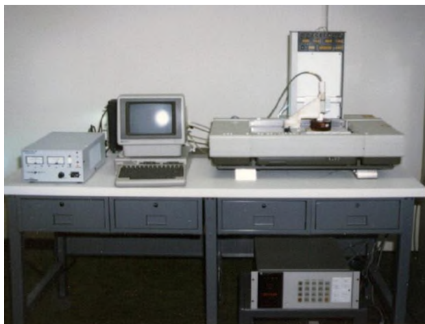
Рис. 1. Перший у світі 3D-принтер "SLA-1", 1984 рік
